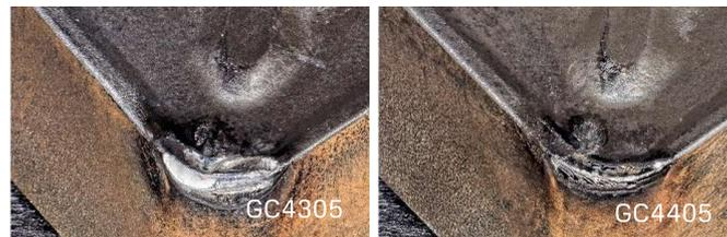
**Resultado:** a classe GC4405 proporcionou um aumento de 130% na vida útil da ferramenta em comparação com a classe GC4305 existente, com base em uma melhor resistência ao desgaste por deformação plástica e craterização.
