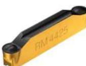
**GC4425:** excelente combinação de alta resistência ao desgaste e boa segurança da aresta. Para ser usada em operações de usinagem de canais, torneamento e corte em condições estáveis em velocidades de corte médias a altas.
